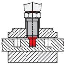
Verstellchiene durch Raststift positioniert, mit der Spannfläche des Raststiftes über den Rändelgriff und die Spannschraube M8 geklemmt.
