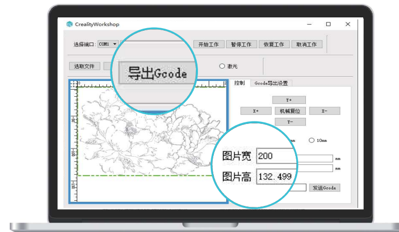
4.把“图片宽”、“图片高”调整打印机打印范围内，点击“导出Gcode”，导出打印文件。
